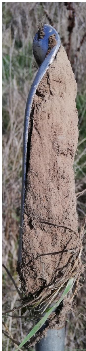
0 cm-20 cm, sondage en prairie au sud-est de la ZIP, non humide, refus 30 cm
